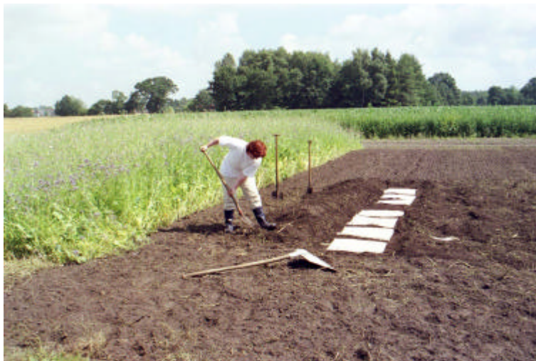
Bild 7: Eingraben der Nadelfilze
