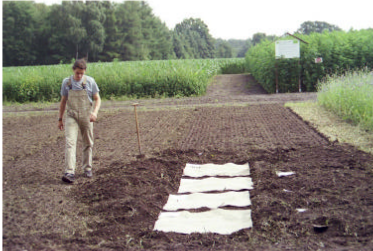
Bild 6: Vorbereitung der Nadelfilze für den Eingrabversuch am Standort Wehnen
