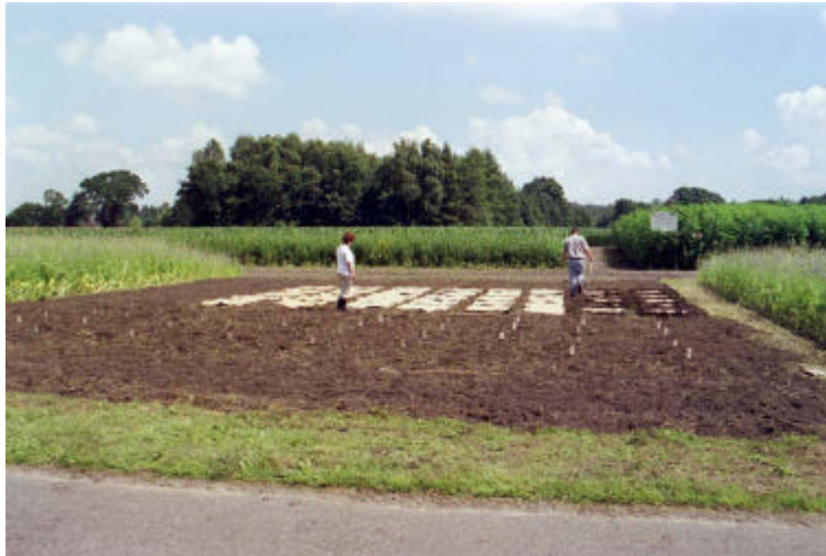
Bild 8: Gesamte Versuchsfläche: eingegrabene Nadelfilze im vorderen Bereich / aufgelegte Nadelfilze im hinteren Bereich
